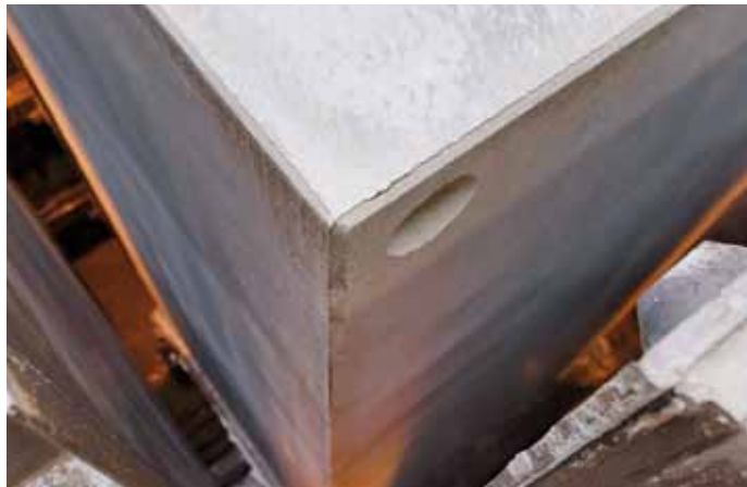
Durch Beheizen der Gussformen wird die chemische Reaktion des Betons unterstützt.
